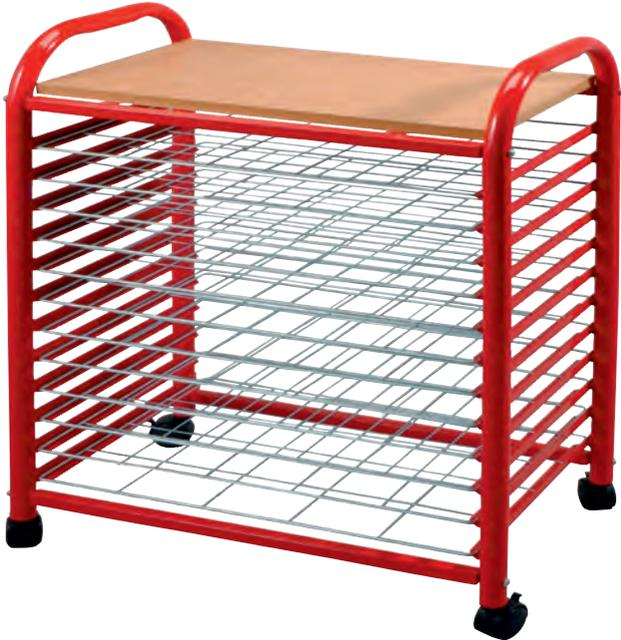
Notre chariot sèche dessins est constitué d'une structure en métal résistant et de 12 grilles amovibles en métal chromé se glissant dans le chariot. Le chariot est mobile grâce à ces 4 roues qui se montent sous le chariot. Deux roues sont munies de frein. Pour le montage vous aurez besoin d'une clé plate n°12 et d'une clé allen n°4 (les clés sont livrées avec le chariot). Le chariot sèche dessins est adapté pour un usage interne uniquement.
