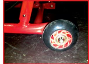
(D+A) Die Achse am Rahmen über das Kugellager mit dem Fußlenker verbinden und mit der Schraube fest fixieren.
