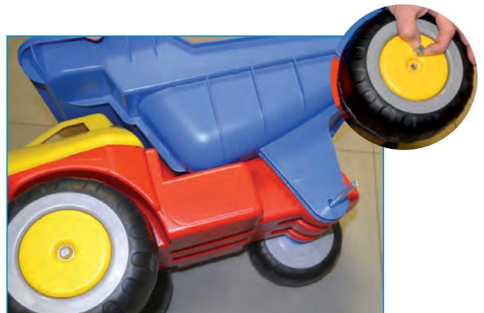
Legen Sie die neue Mulde auf den Boden und stecken die Achse durch das **Zwillingsloch** von der Mulde. Stecken Sie Rad und Felge auf. Nun setzen Sie die neue Kappe (2) gerade auf das Ende der Achse und schlagen diese mit einem Hammer fest auf die Achse.
