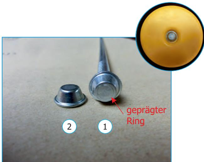
Die Räder sind mit Achskappen auf der Achse befestigt. Auf einer Seite hat die Kappe einen geprägten Ring (1). Diese Kappe ist fest und nicht ablösbar. Die ablösbare Achskappe hat einen glatten Kopf (2).
