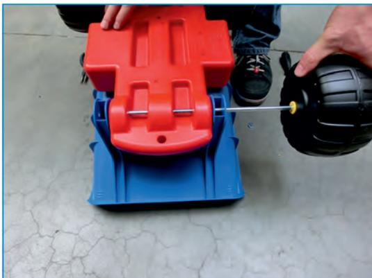
Nehmen Sie das Rad ab. Ziehen Sie die Achse heraus und entfernen die defekte Mulde.
